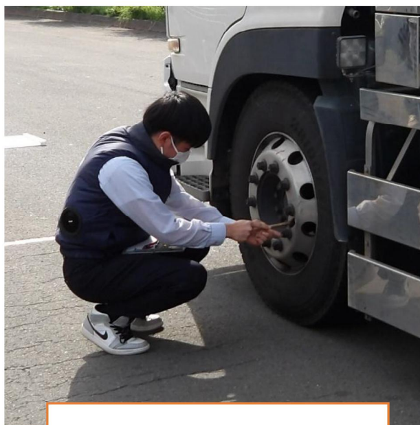
ホイール・ナットの点検調査
