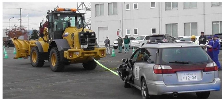
＜除雪ドーザによる牽引＞
