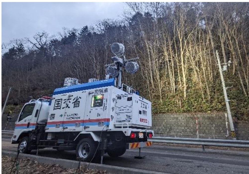
【落石発生箇所における現地調査への支援(照明車)】
