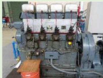
排水機の油漏れ・塗膜劣化
