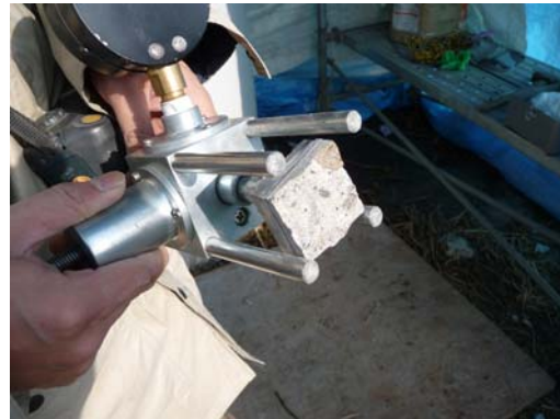
写真-13 付着強度試験後の状況一例
