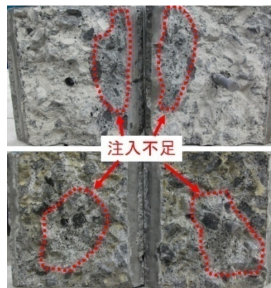
注入不足の供試体例 下：ポリマー系、上：超微粒子ポリマーセメント系
