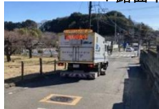
(空洞探査車による調査)
