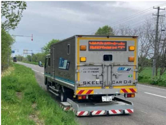
路面下空洞調査状況
