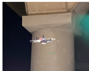
ドローンによる高解像度写真から柱のひび割れを展開図に整理し、今後の維持管理の記録として保存しています
