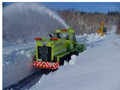
ロータリ除雪車による作業状況
