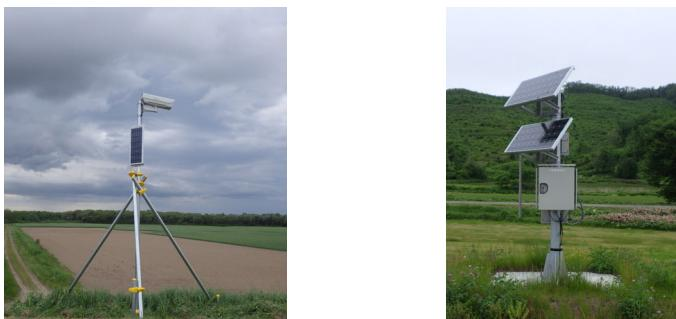
図 2-8 簡易型河川監視カメラ(左)、危機管理型水位計(右)
