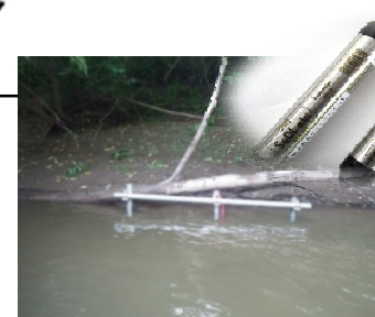
簡易水位計などの設置
