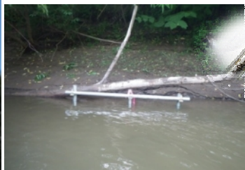
簡易水位計などの設置
