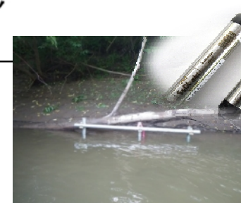
簡易水位計などの設置
