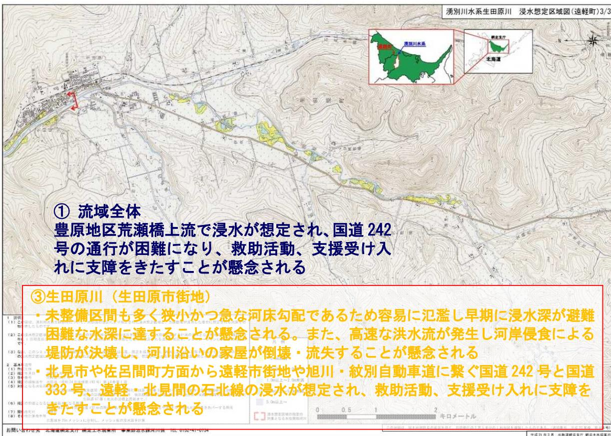
図 道管理区間における想定最大規模の降雨による浸水想定区域と想定される被害の特徴
