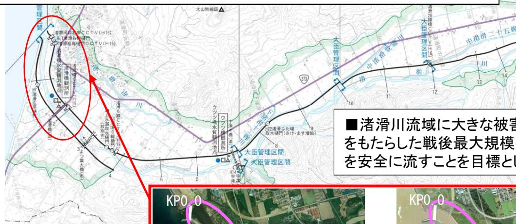
■ 渚滑川流域に大きな被害をもたらした渚滑川流域に大きな被害をもたらした戦後最大規模の洪水である平成10年9月洪水の流量を安全に流すことを目標とした河道掘削の実施
