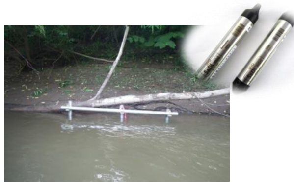
簡易水位計などの設置
