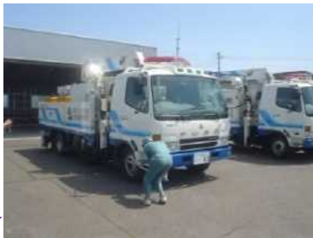
排水ポンプ車
