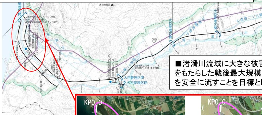
■ 渚滑川流域に大きな被害をもたらした渚滑川流域に大きな被害をもたらした戦後最大規模の洪水である平成10年9月洪水の流量を安全に流すことを目標とした河道掘削の実施
