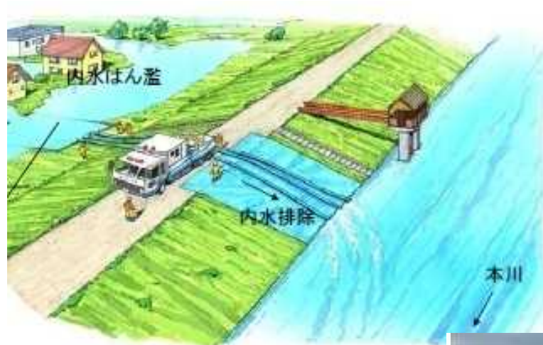
排水活動を行うスペースの整備検討
