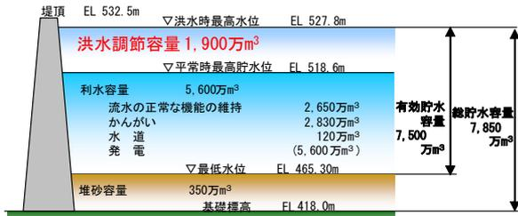
新たに1,900万m³の洪水調節容量を確保
