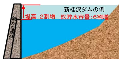
全国のダム(1460ダム)による洪水調節機能の早期の強化に向け、水系毎に、ハード対策とソフト対策を一体として、効率的・効果的に取り組むことが必要。
