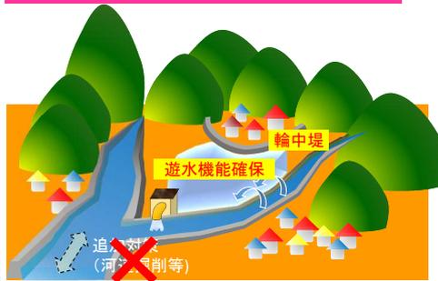
輪中堤又は遊水地の整備により、**遊水機能を確保しつつ家屋浸水を防衛**
