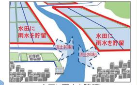
水田に雨水を貯留し下流への流出を抑制
