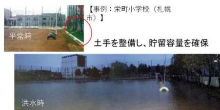
開発に伴う雨水の河川への流出量の増大に対して、雨水貯留浸透機能を回復させるための代替措置
