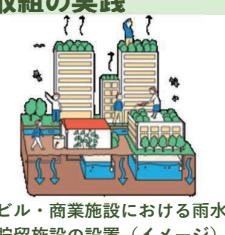
ビル・商業施設における雨水貯留施設の設置（イメージ）
