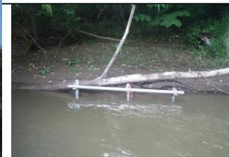
簡易水位計などの設置
