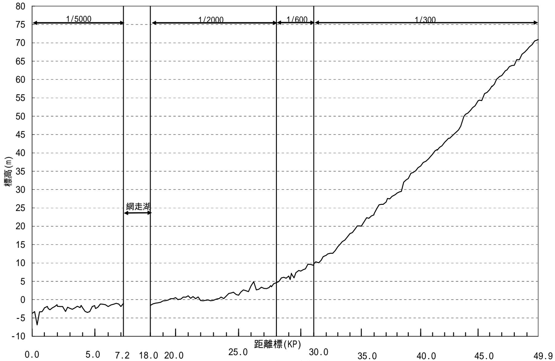
図 8-1 網走川河床高縦断面図
