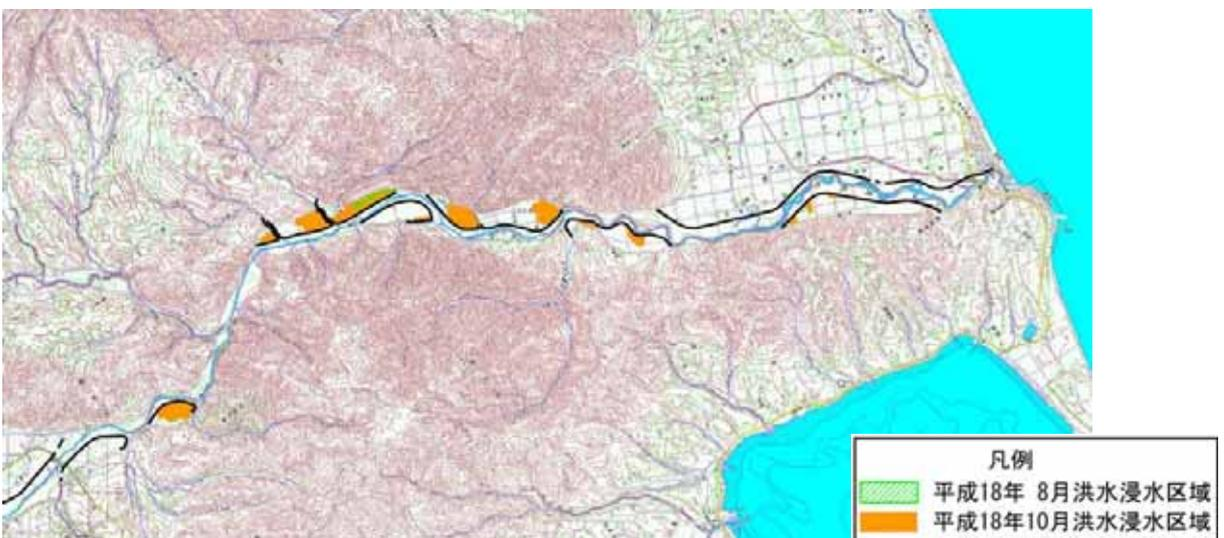
図 1-9 洪水被害 浸水実績図
