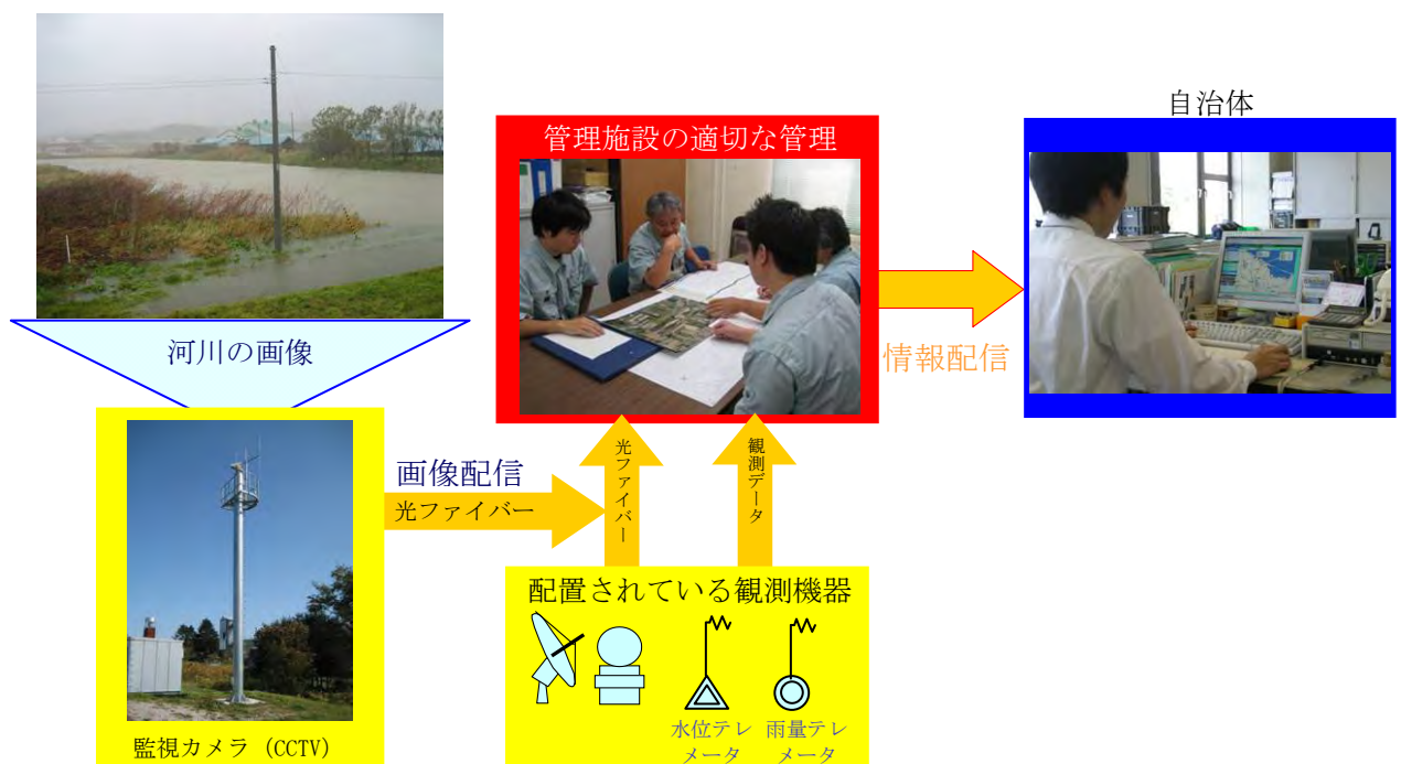
図 2-4 光ファイバー網による河川情報の収集・伝達のイメージ図
