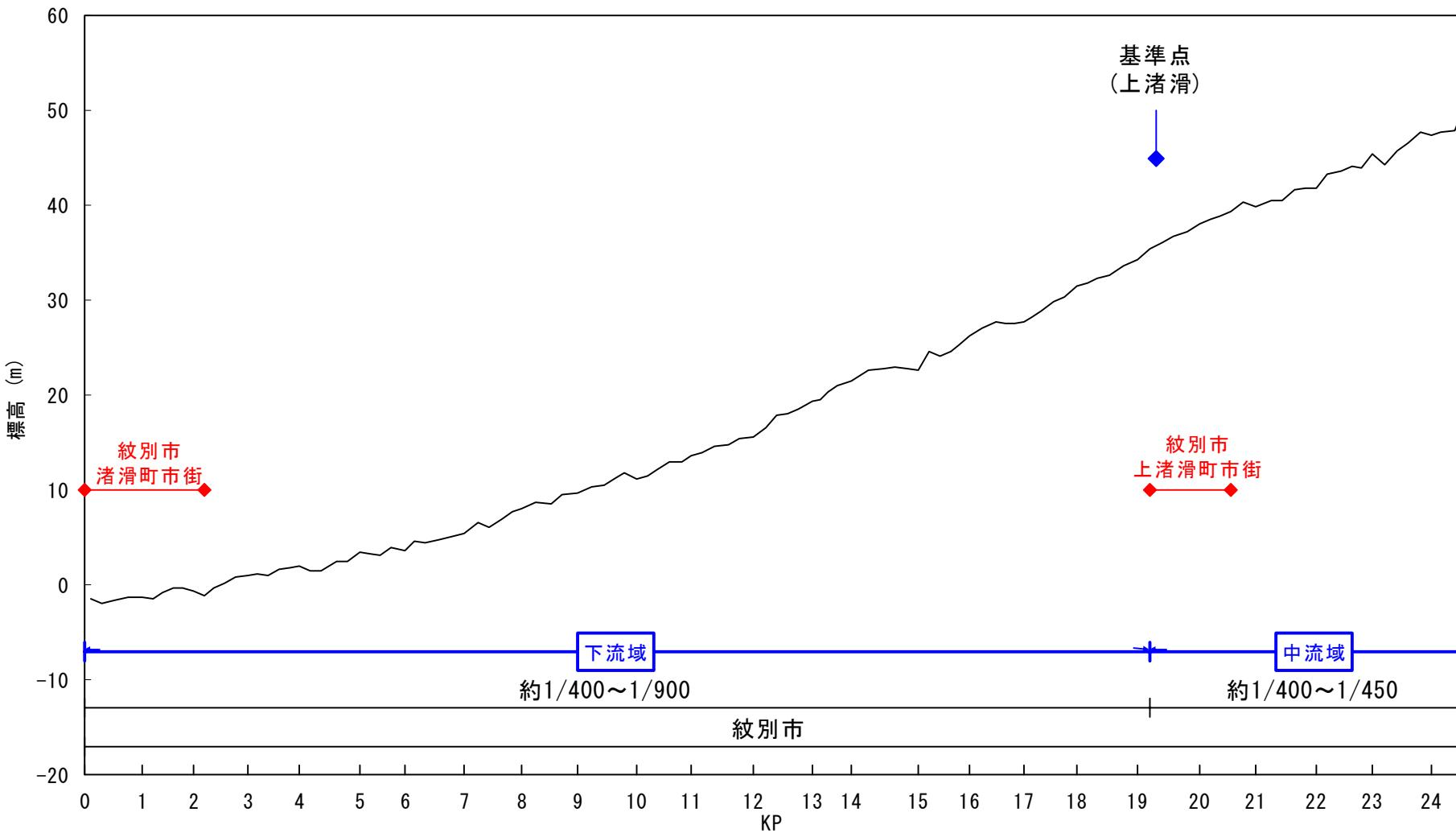
図 8-1 渚滑川水系 渚滑川 河床高縦断図（直轄管理区間）
