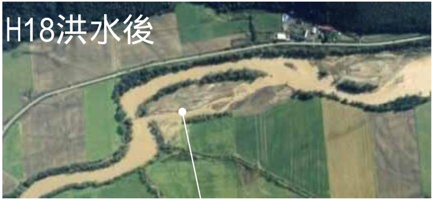
記念橋より上流の区間は、目標流量を安全に流すための断面が不足するが、堤防もなく掘込河道であり、氾濫域が拡散しにくい。
