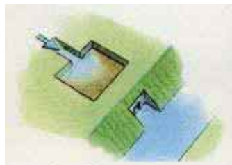
【流入対策工】 排水路本川の手前で土砂を沈降させ、下流への土砂流入を防止する。
