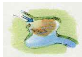
【幅広水路工】 排水路本川に沈砂機能をもたせて、土砂の流出を防止する。
