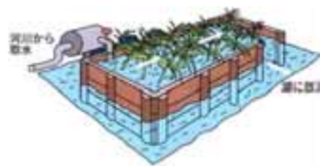
【植生浄化試験施設】
