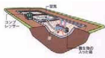
【微生物浄化施設】
