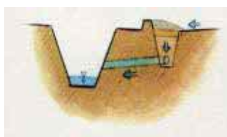
【排水路保護工】 農地から排水路への土砂流入を圃場段階で防止する。
