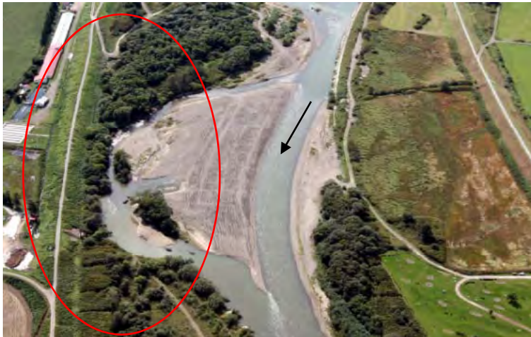
必要な高水敷幅が確保されていない区間の例 (KP4付近:H19当時)
