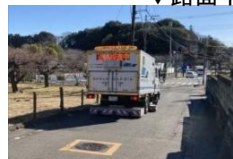
(空洞探査車による調査)
