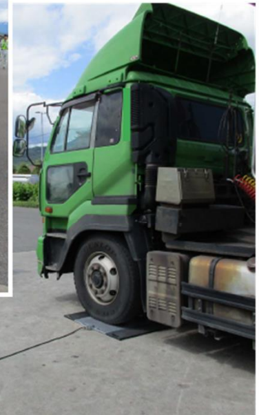
車両重量計測装置による重量測定
