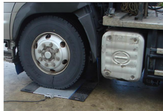
車両重量計測装置による重量測定
