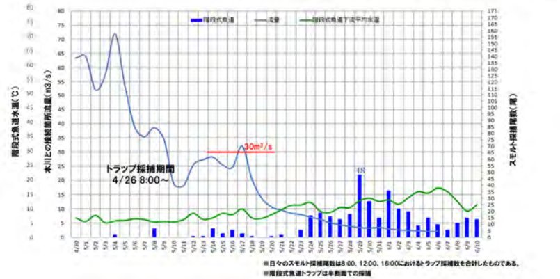
図- 41（参考）階段式魚道地点のスモルト降下状況とサンル川流量（令和元年, 平成 30 年）
