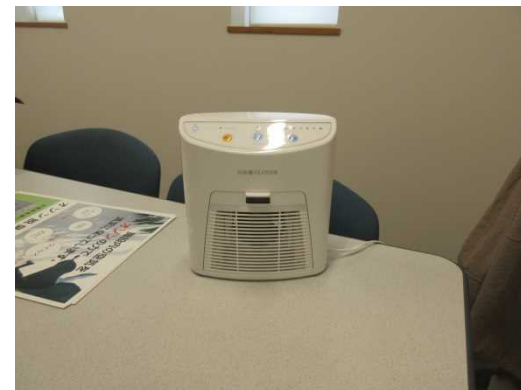
オゾン脱臭器
