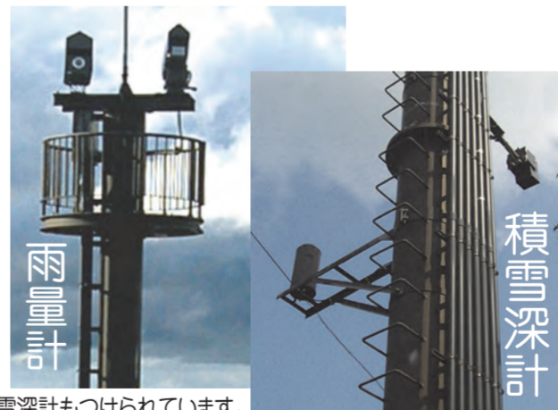
この塔には、雨量計や雪の深さを測る積雪深計もつけられています。
