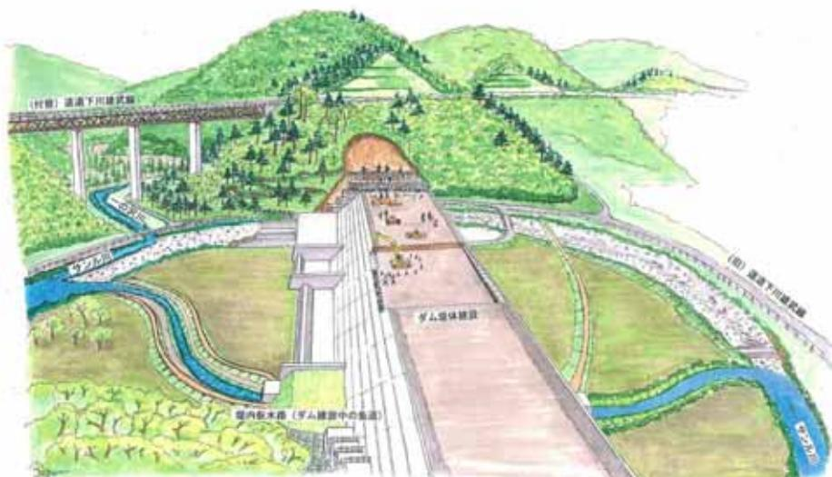
図-61 魚道施設の機能確認工程と堤体内水路のイメージ図
