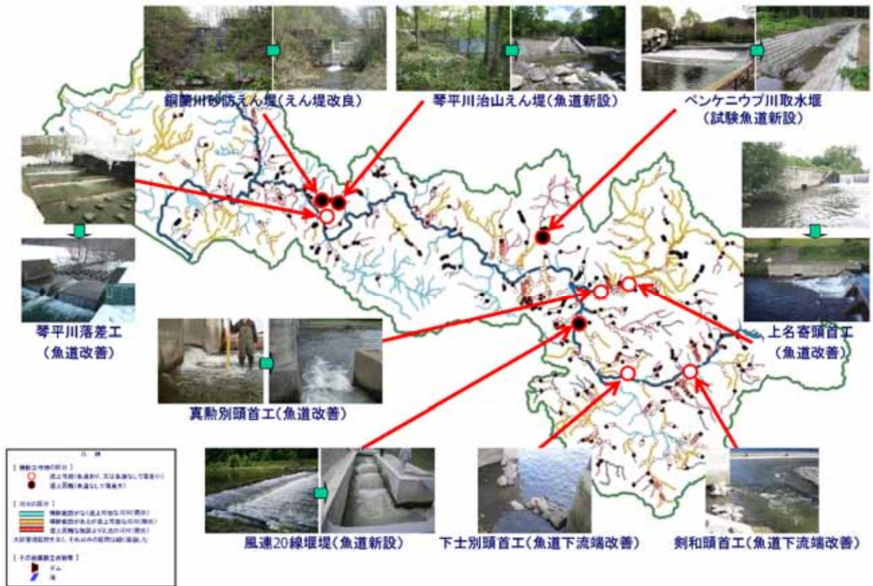
図-19 魚道新設・改善箇所位置図(平成21年度実施)
