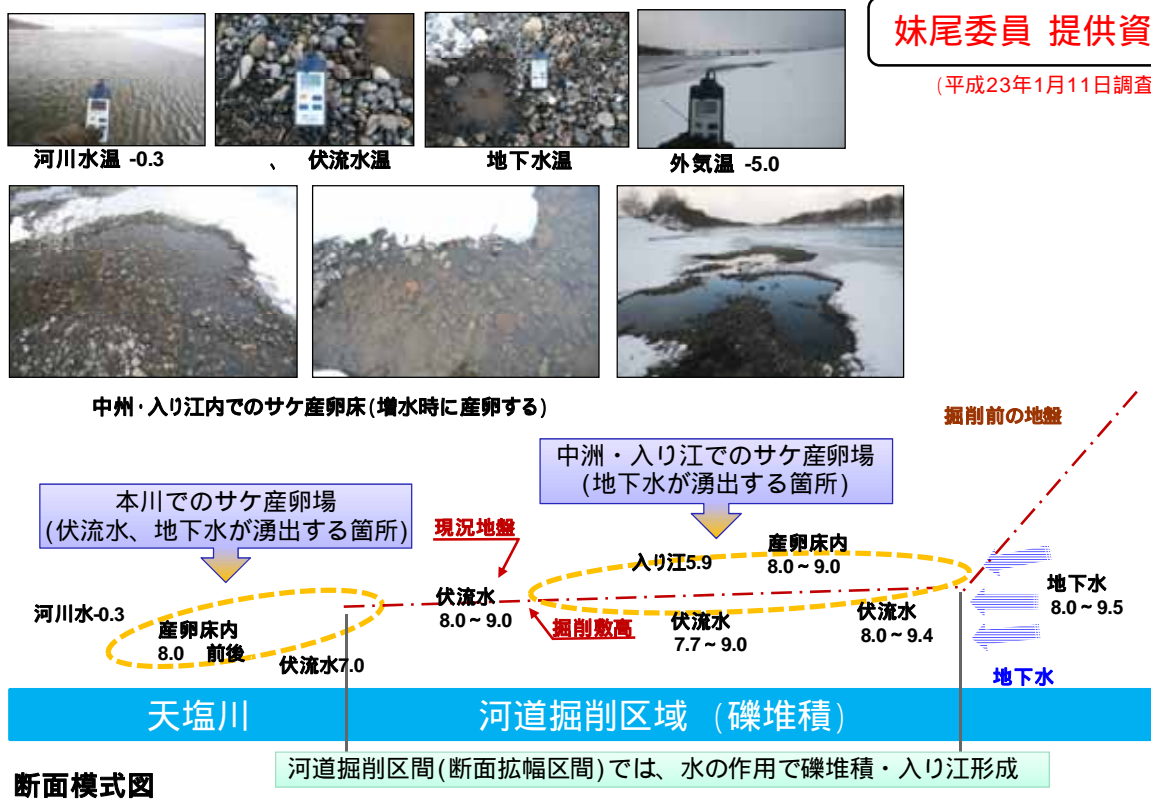
図-17 河道掘削区間におけるサケの産卵場の模式図
