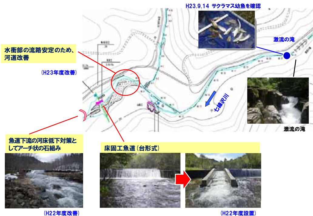
図-27 七線沢川床固工魚道
