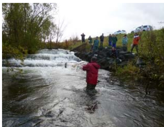
ピヤシリ川落差工の流況確認 と魚類調査状況
