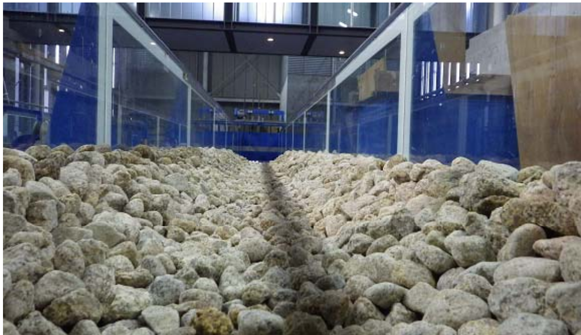
石組み台形断面水路(設置完了の状態)
