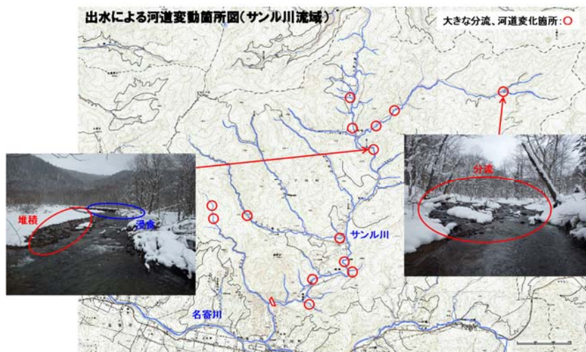
図- 17 サンル川流域の出水（平成 26 年 8 月）による河道変動箇所図
