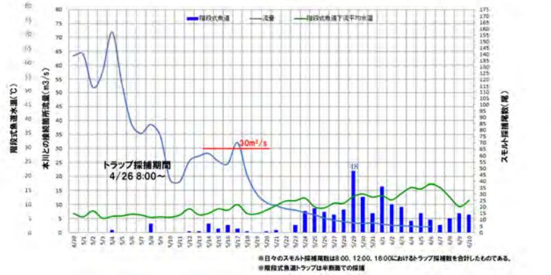
図- 41（参考）階段式魚道地点のスマルト降下状況とサンプル川流量（令和元年, 平成 30 年）
