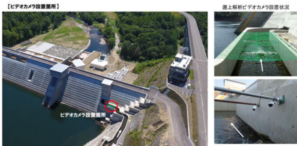
写真- 16 遡上解析ビデオカメラ設置状況
