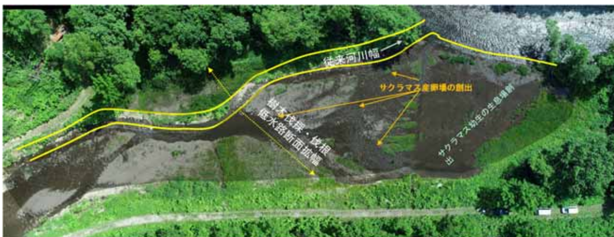
図-14 ペンケ10号川 河畔林伐採と低水路拡幅箇所
