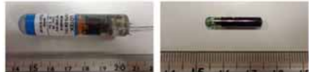
写真-21 電波発信機とピットタグ
