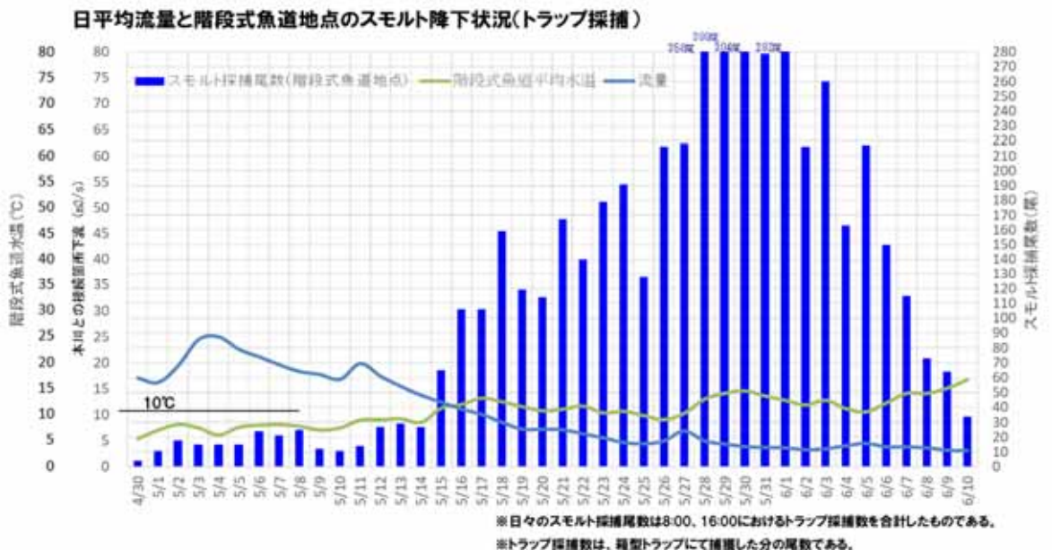
図- 48 階段式魚道地点のスマルト降下状況とサンル川流量[本川との接続箇所地点]（令和7年）
