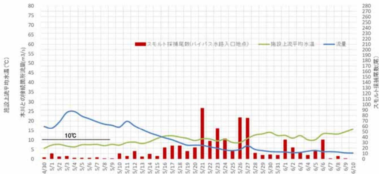
日平均流量とバイパス水路入口地点のスマルト降下状況(トラップ採捕)
