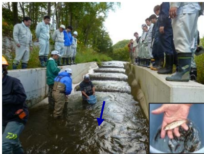
ポントーフトナイ川(落差工①) 魚道の流況・生息魚類確認
