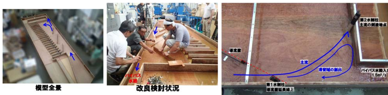
図- 42 施設改良のための模型実験状況
