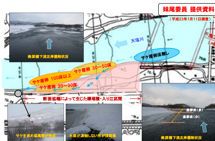
図- 29 河道掘削区間におけるサケの産卵状況
