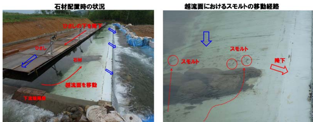
写真- 17 試験余水吐のスモルト降下状況
