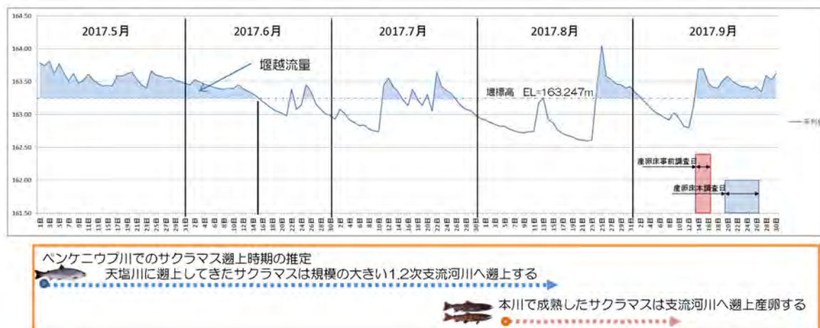
図- 15 ペンケニウプ川取水施設天端高以上の河川水位状況と親魚遡上状況
