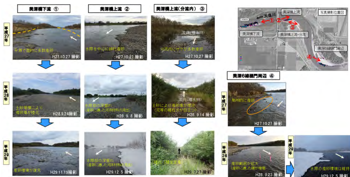
写真-18 美深橋周辺における出水(H28 年 8 月)前後の河道状況
